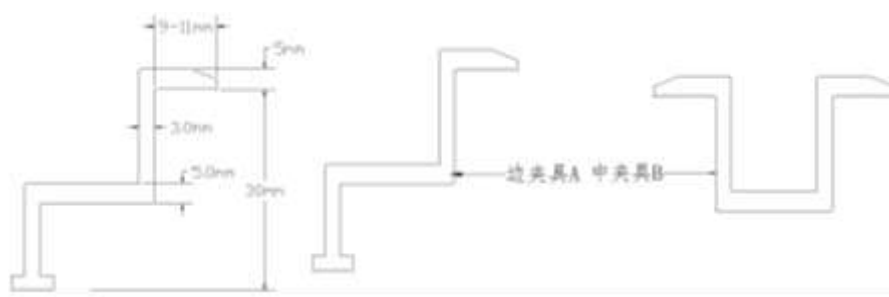
(Figura 2: Diagrama de fixação do módulo fotovoltaico regular)
