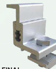
GRAMPO FINAL COD.: IZI 201 Material: Alumínio 6063-T5 | Inox 304 Altura: 30 à 40mm Acompanha: Parafuso Sextavado inox e porca de alumínio.
