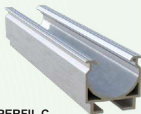
PERFIL C COD.: IZI051 Material: Alumínio 6063-T5 Distância máx. entre apoios: 1,50m Tamanho disponível: 2,40m e 4,80m
