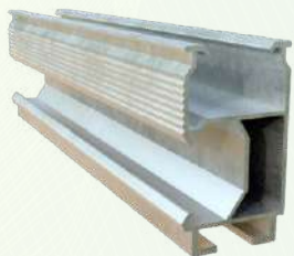
PERFIL C REFORÇADO COD.: IZI009 Material: Alumínio 6063-T5 Distância máx. entre apoios: 2,00m Tamanho disponível: 2,40m e 4,80m
